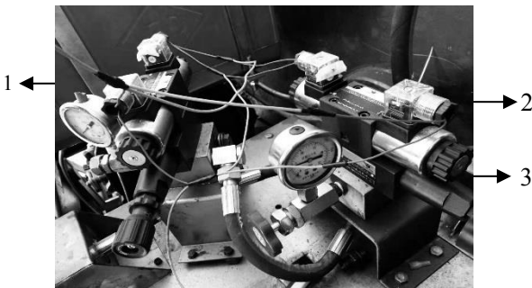
图4 液压控制阀组结构图
